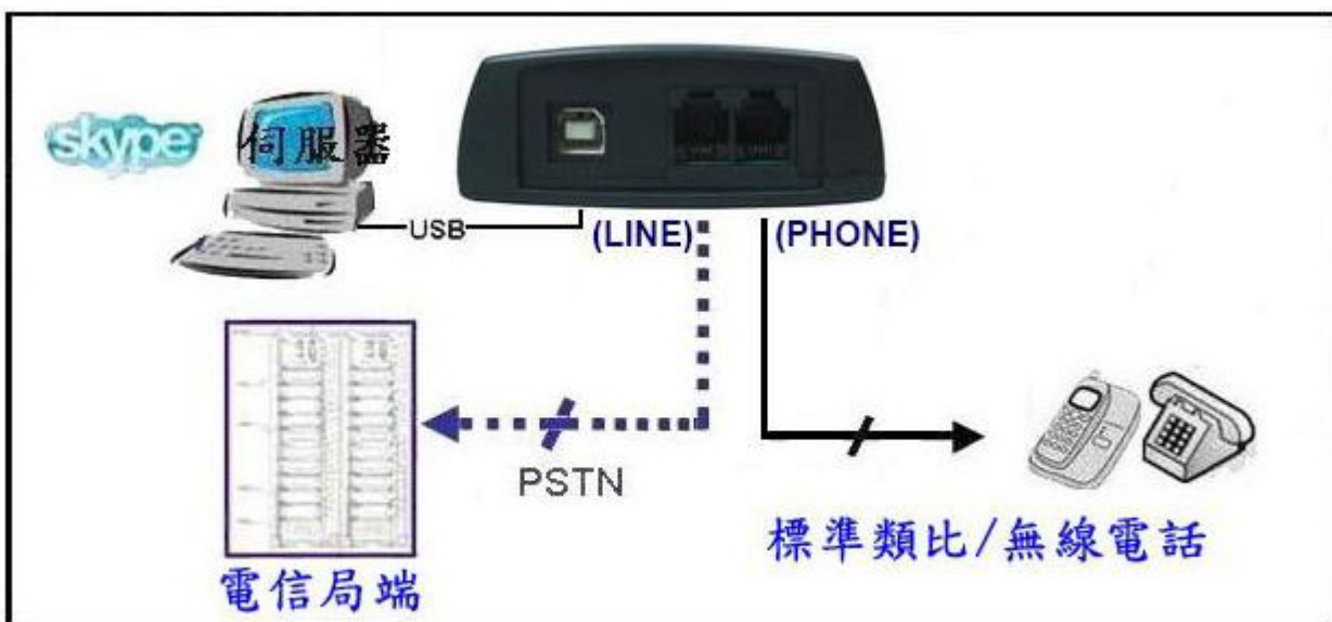
連接到標準的電話機和電信局局端(家庭RJ11牆壁接口)
